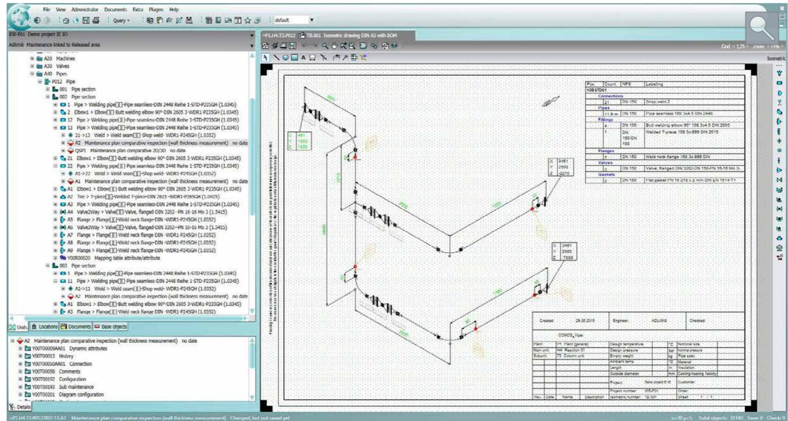
Einfache Platzierung von Prüf- und Wartungspunkten direkt auf der Isometrie
