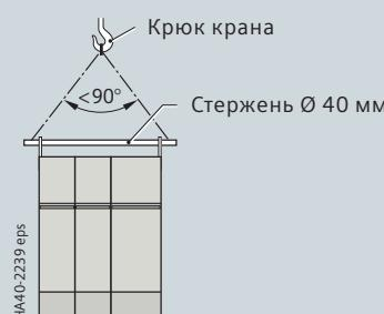
Транспортировка краном с помощью стержня
