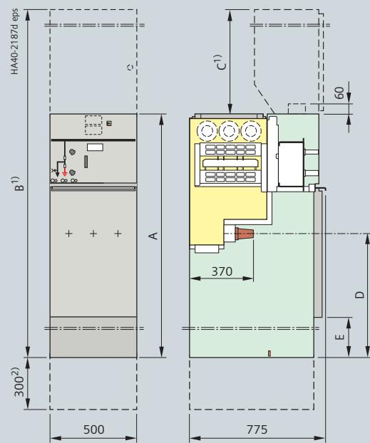
Ячейка силового выключателя, тип L(500)
