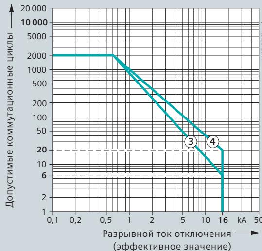
Номинальный ток отключения при коротком замыкании 16 кА
