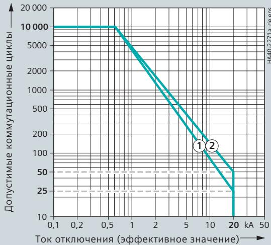
Номинальный ток отключения при коротком замыкании 20 кА
