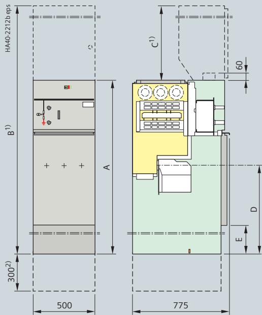
**Измерительная ячейка, тип М(430)
