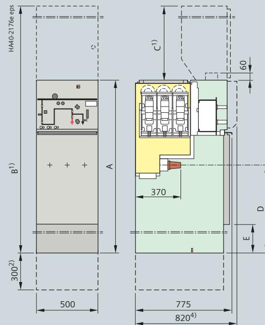
**Вариант исполнения** с трансформатором напряжения на сборной шине для всех типов силовых выключателей
