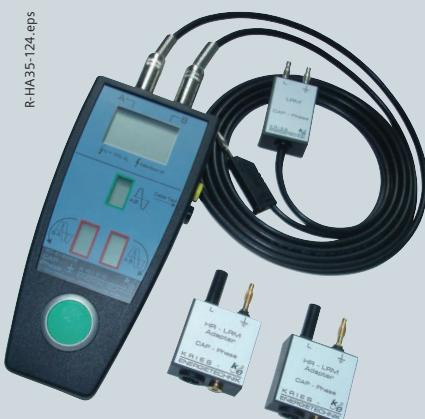
**Испытательное устройство сравнения фаз производства Kries, Тип CAP-фаза**
