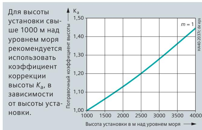
Кривая  $m = 1$  для номинального кратковременного испытательного переменного напряжения и номинального испытательного импульсного напряжения грозового разряда в соответствии со стандартами IEC/EN 62271-1 / VDE 0671-1.
