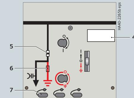
Панель управления ячейки трансформатора
