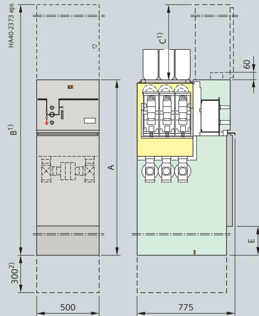
**Продольная разъединительная ячейка сборной шины, тип Н**
