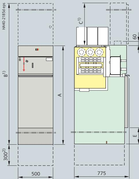
**Измерительная ячейка, тип М(500)
