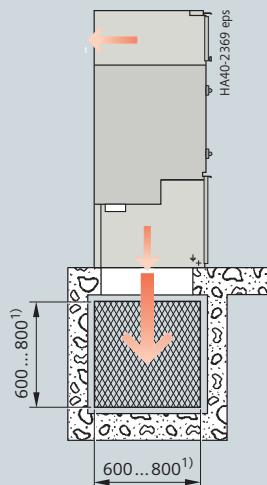
**Размещение ячейки в корпусе для наружной установки со сбросом давления назад или вверх через задний канал**
