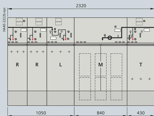
Передача при помощи силового выключателя в блоке ячеек и соединения кабелей (RRL-M-T...)
