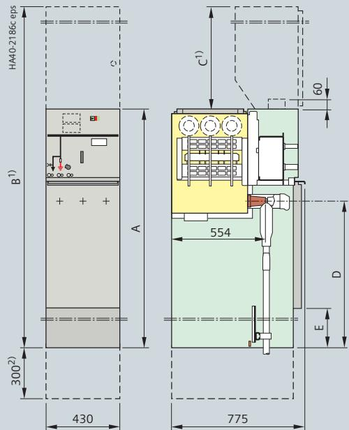
**Трансформаторная ячейка, тип Т**
