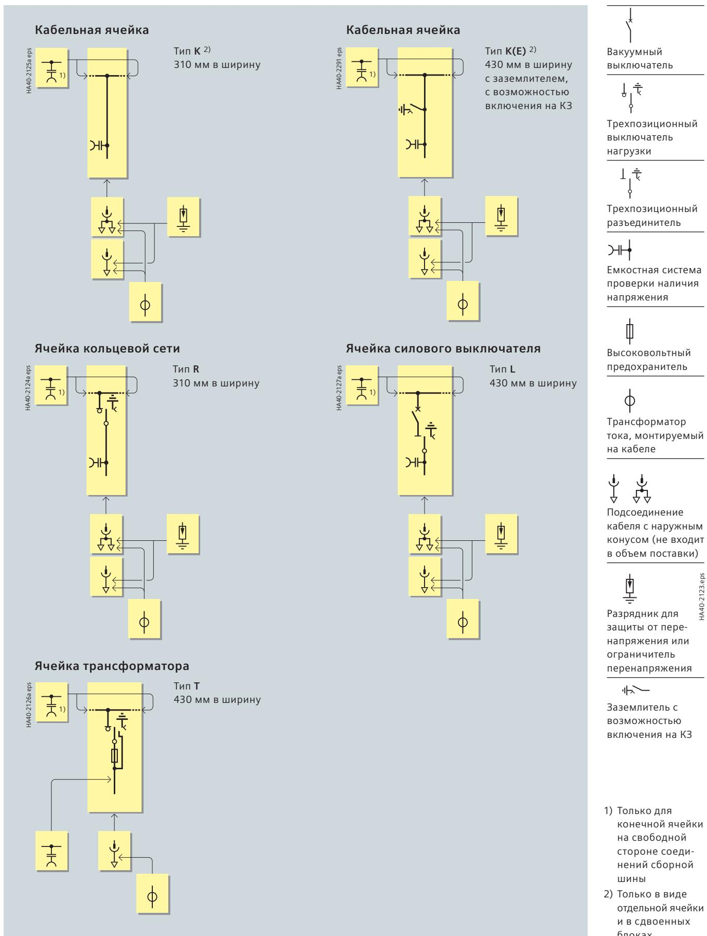
1) Только для конечной ячейки на свободной стороне соединений сборной шины
