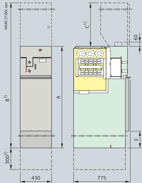
**Продольная разъединительная ячейка сборной шины, тип S(620)**
