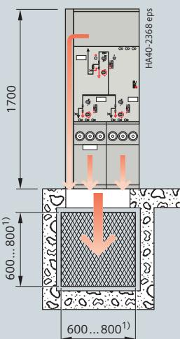
**Размещение ячейки в корпусе для наружной установки со сбросом давления вниз**
