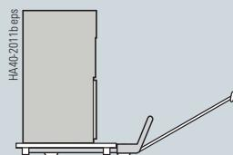
Транспортировка с помощью автопогрузчика с поддона или без него
