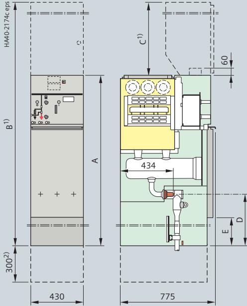
**Ячейка силового выключателя, тип L**
