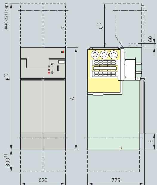
**Продольная разъединительная ячейка сборной шины, тип S(500)**
