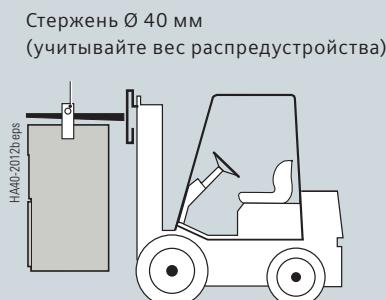
Транспортировка вилочным автопогрузчиком, подвесная
