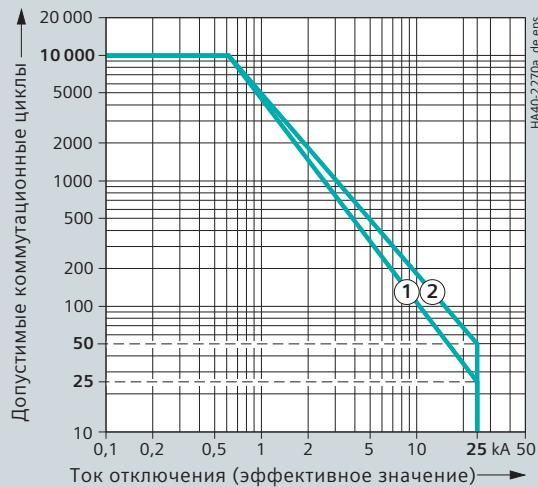
Номинальный ток отключения при коротком замыкании 25 кА
