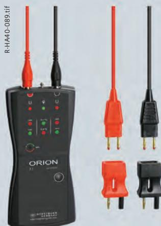
**Устройство сравнения фаз производства Horstmann, тип ORION 3.1**
