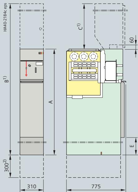
**Ячейка заземления сборной шины, тип Е(500)
