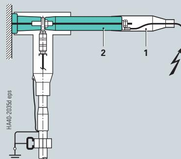
Испытание кабеля в месте расположения кабельного Т-образного адаптера (Пример)
