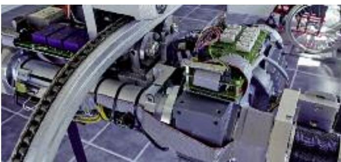
Die Antriebseinheit aus einem anderen Blickwinkel: Der Hub-/Senkmotor treibt über eine quer zum gesamten Antrieb geführte Schneckenwelle die Aufrollmechanismen der Traggurten an. Das Getriebegehäuse des Motors ist gleichzeitig integrierter Bestandteil der Konstruktion.
