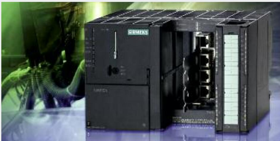
Mit dem neuen Controller Simotion C240 PN bietet Siemens das Motion-Control-System Simotion in S7-300-Bauform mit Profinet-Schnittstelle. Damit können bis zu 32 Motion-Control-Achsen hoch performant geregelt werden. Ein Speicherausbau von 35 MB erlaubt zudem den Einsatz des C240 PN als effiziente Maschinensteuerung in komplexeren Maschinen und Anlagen. In Verbindung mit der schnellen Profinet-Peripherie ET 200S High Speed ist der Controller prädestiniert für Regelungs-
