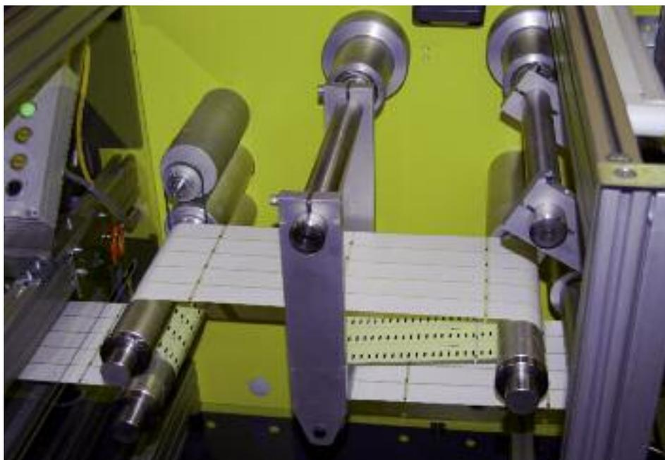
Die Maschinen von Faes decken die letzte Produktionsstufe der Etiketten-Verarbeitung ab: der Zuschnitt der Etiketten auf Breite und Länge sowie die Aufwicklung auf anwendergerechte Rollen.
