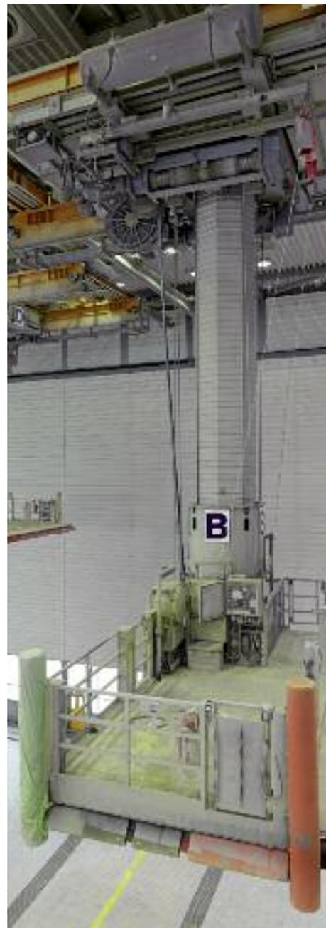
Die an Matrix-Kranbahnen hängenden Arbeitsplattformen werden teleskopartig nach unten und oben bewegt.
