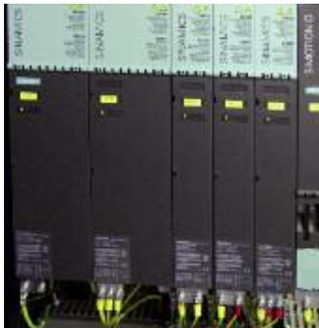
Das Motion Control System Simotion D435 in Verbindung mit dem Antriebssystem Sinamics S120 bildet das Rückgrat des Antriebskonzeptes der neuen Schneid-/Wickelmaschinen.
