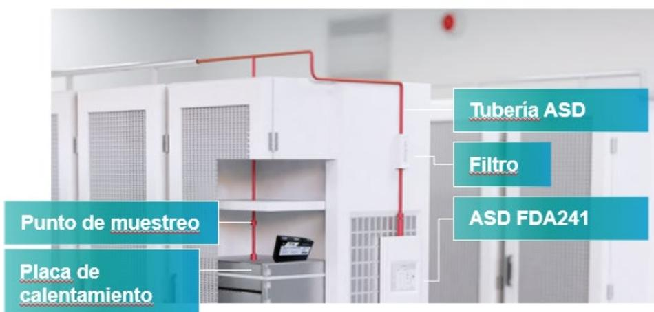
Figura 8: Estructura principal de la configuración de prueba de detección de una fuga térmica
