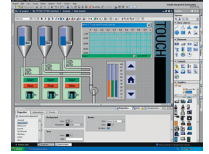
WinCC HMI Projelendirme
