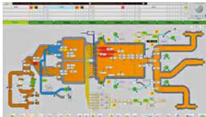
Die Visualisierung mit PCS 7 ermöglicht die uneingeschränkte und einfache Bedienung und Überwachung der Anlage
