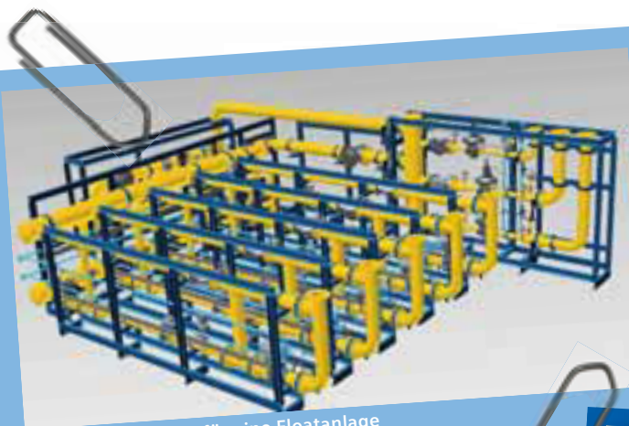
Befeuerungssystem für eine Floatanlage
