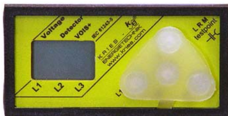
Рисунок 48: Индикатор напряжения, тип VOIS+
