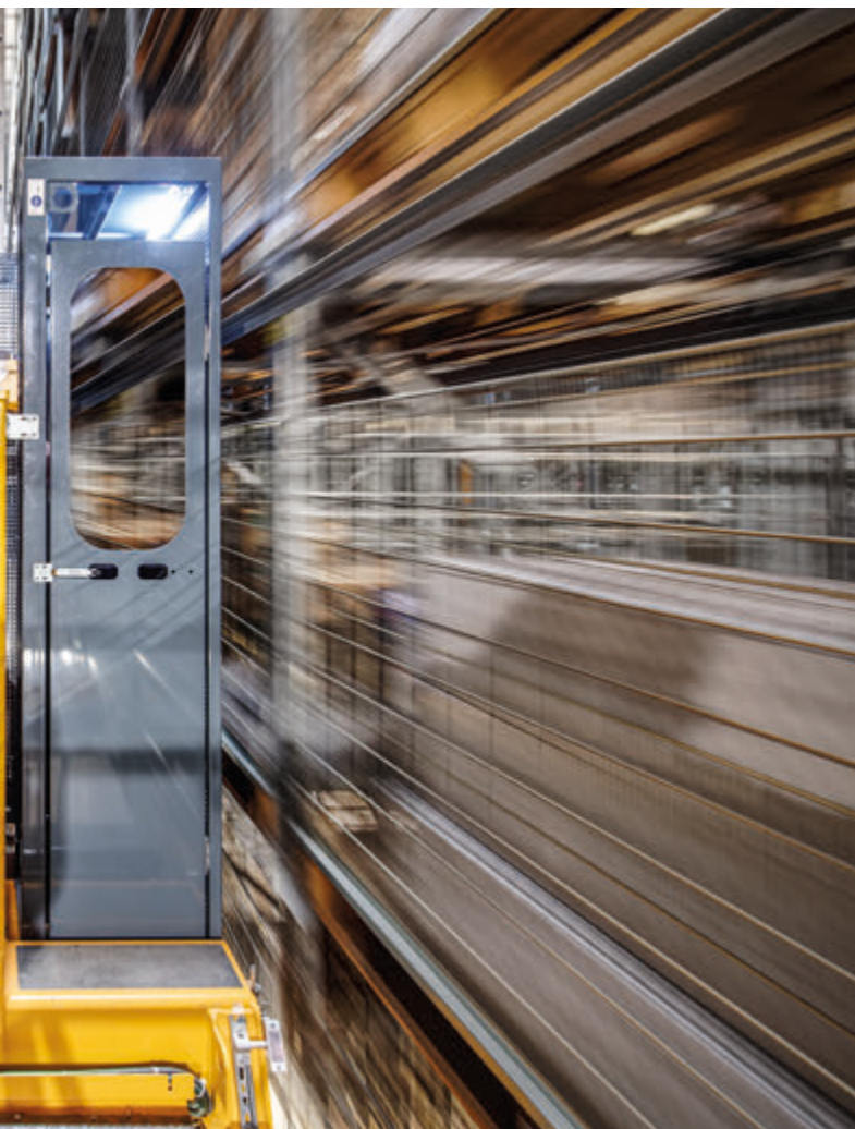
Jedes der fünf Regalbediengeräte wird von einer eigenen Simatic S7-1500F gesteuert. Die Steuerungen spielen perfekt mit dem Lagerverwaltungssystem von Emil Frey zusammen.
