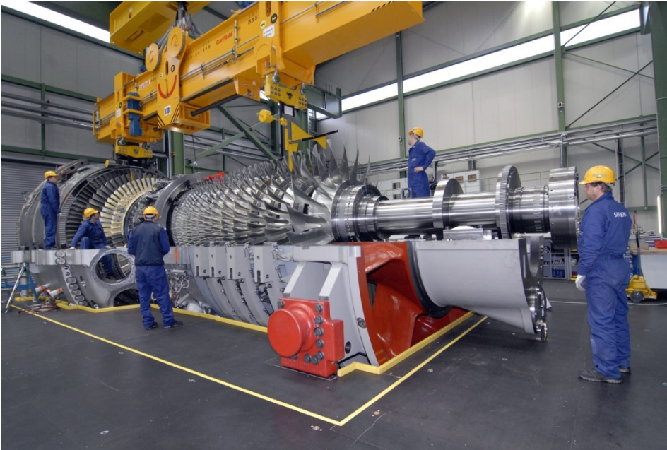
Endmontage einer SGT5-8000H im Siemens Gasturbinenwerk in Berlin
