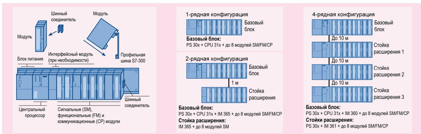
Все центральные процессоры S7-300 оснащены встроенным интерфейсом MPI, который используется для программирования, диагностики и построения простейших сетевых структур. В CPU 31...-2PN/DP, 317 и 319 первый встроенный интерфейс имеет двойное назначение и может использоваться для подключения либо к сети MPI, либо к сети PROFIBUS DP.
