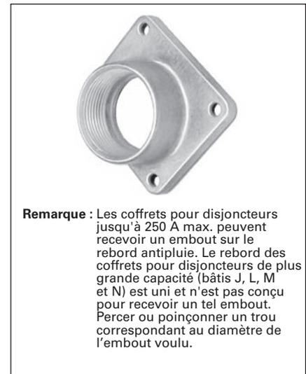
**Remarque :** Les coffrets pour disjoncteurs jusqu'à 250 A max. peuvent recevoir un embout sur le rebord antipluie. Le rebord des coffrets pour disjoncteurs de plus grande capacité (bâti J, L, M et N) est uni et n'est pas conçu pour recevoir un tel embout. Percer ou poinçonner un trou correspondant au diamètre de l'embout voulu.
