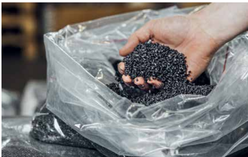
Износените изделия и отпадъци от въглеродни влакна се превръщат в рециклиран материал, използван при 3D принтиране или лее-не под налягане
