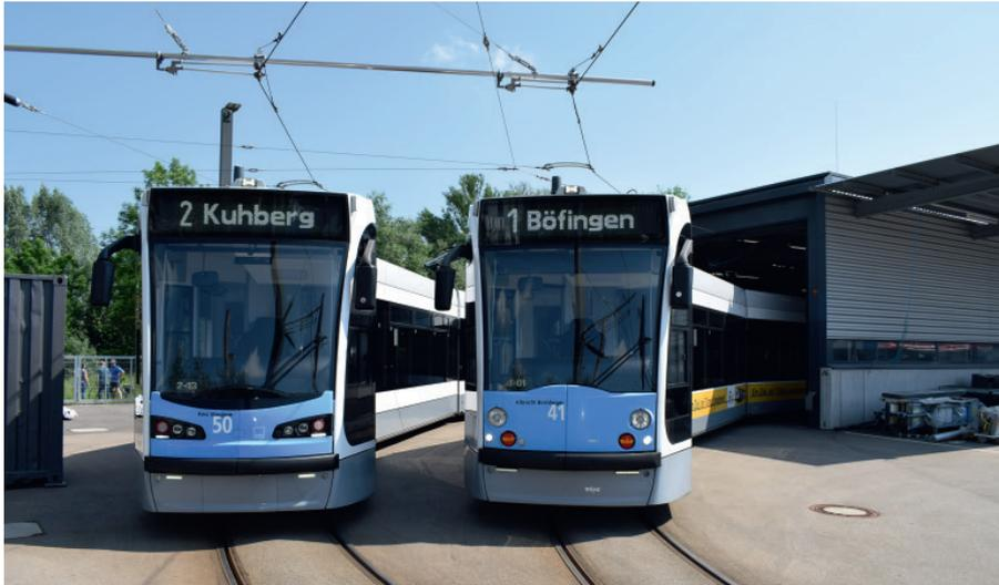
2: Combino® rechts mit herkömmlicher und links mit Re-Designter und Re-Engineerter Bughaube
