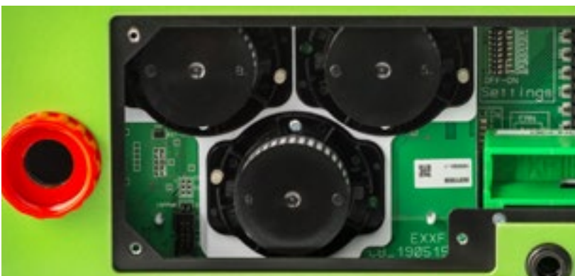
Les trois capteurs optiques permettent une détection fiable et précise.
