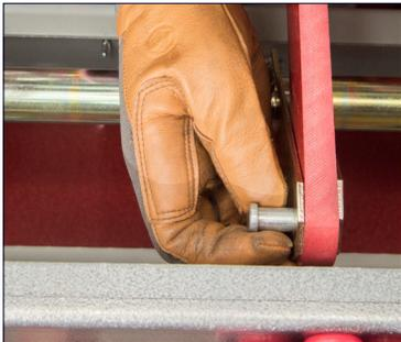
Figure 41 : Débranchez les tiges de poussée
