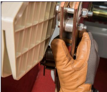
Figure 42 : Désengager les lames de l'interrupteur
