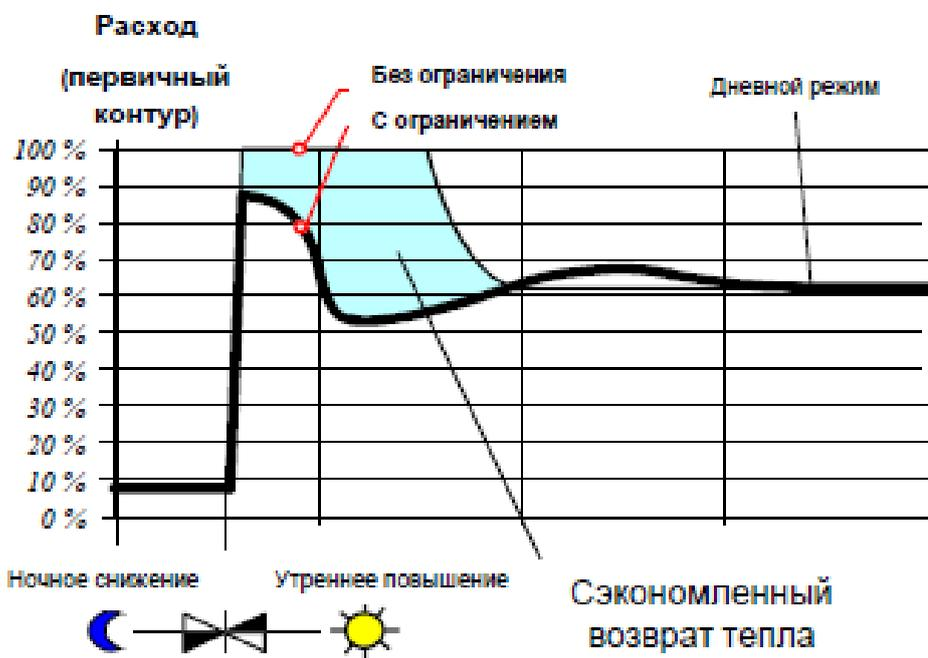
При автоматическом переключении на ночной режим клапан начинает прикрываться до положения примерно <10% открытия. При этом расход теплоносителя первичного контура сокращается примерно в 6 раз.
