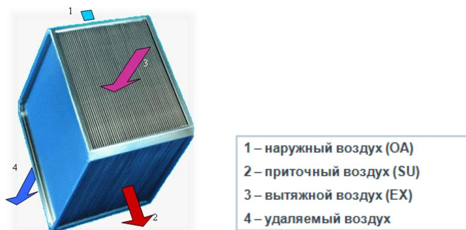
Пластинчатый рекуператор представляет собой блок теплообменника, оснащенный множеством тонких листов-перегородок, через которые обеспечивается процесс передачи тепла от удаляемого воздуха к приточному. Потoki удаляемого и приточного воздуха проходят между перегородками по разные стороны под прямым углом друг к другу, не пересекаясь и не смешиваясь. Эффективность рекуперации тепла выражается коэффициентом возврата  $\Phi_{su}$  и колеблется в пределах: 45...70 %.
