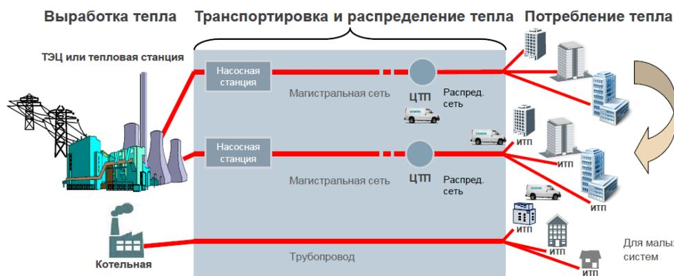
Схема централизованного теплоснабжения состоит из трёх составляющих: выработка тепла, транспортировка и распределение тепла и, наконец, потребление тепла.
