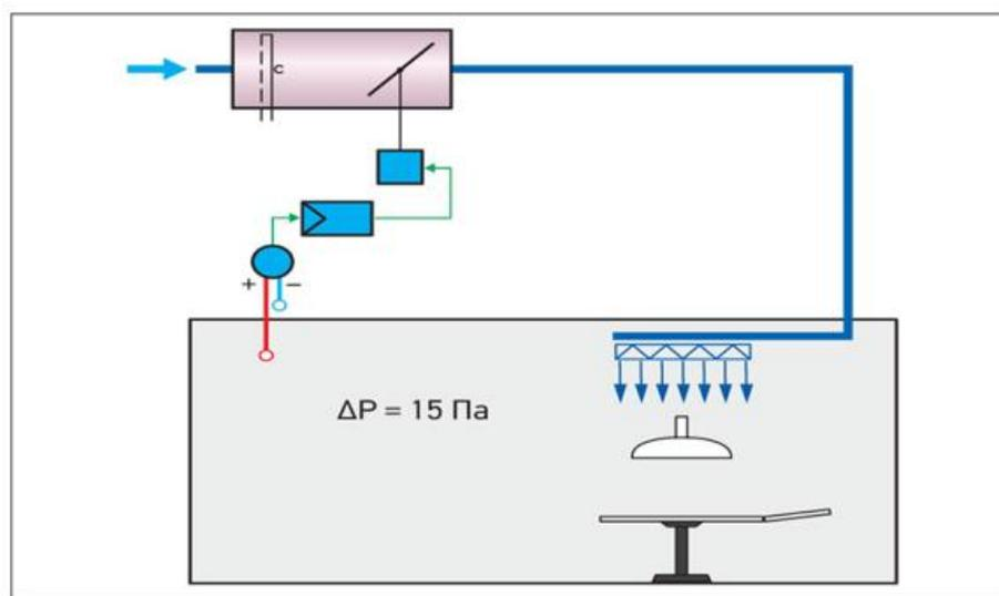
В этом случае блок регулирования в вытяжном воздуховоде не нужен, поскольку нет необходимости в балансировании притока и вытяжки.
