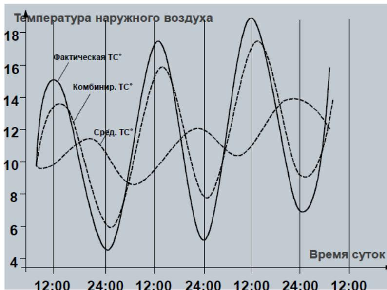
Контроллер отопления определяет фактическую температуру наружного воздуха, подсчитывает среднюю и задаёт комбинированную, соответствующую инерционности конструкции данного здания.
