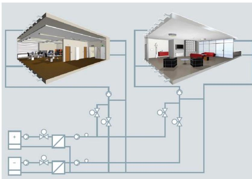
Если накопительный максимум перекрытия не обеспечивает потребность помещения зимой в обогреве, а летом в охлаждении, то можно частично использовать обычные системы обогрева или охлаждения, а также нетрадиционные системы, использующие энергию окружающей среды: воздуха, воды, грунта и др. Правильное использование теплоёмкости конструкции здания усредняет дневные и ночные перепады температуры и уменьшает затраты энергии.
