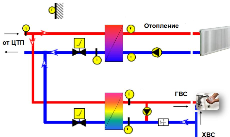
Трубопроводы от ЦТП подводятся параллельно к двум теплообменникам: отопления и ГВС.
