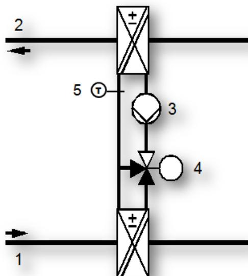
Рекуператор этого типа применяется, когда приточный и вытяжной воздуховоды разведены по разным этажам, и нет возможности свести их в общем рекуператоре. Тогда на каждом из этих воздуховодов устанавливается по калориферу, и между калориферами циркулирует теплоноситель, например, вода-гликоль. Для регулирования степени рекуперации и для защиты от обледенения используется датчик температуры 5 и регулирующий клапан 4.
