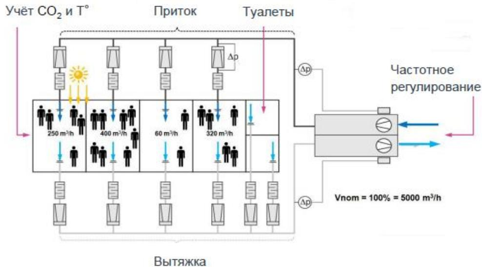
Установка блоков регулирования не только в притчном воздуховоде, но и в вытяжном обусловлено необходимостью сбалансировать приток и вытяжку. Поэтому они должны работать согласованно.
