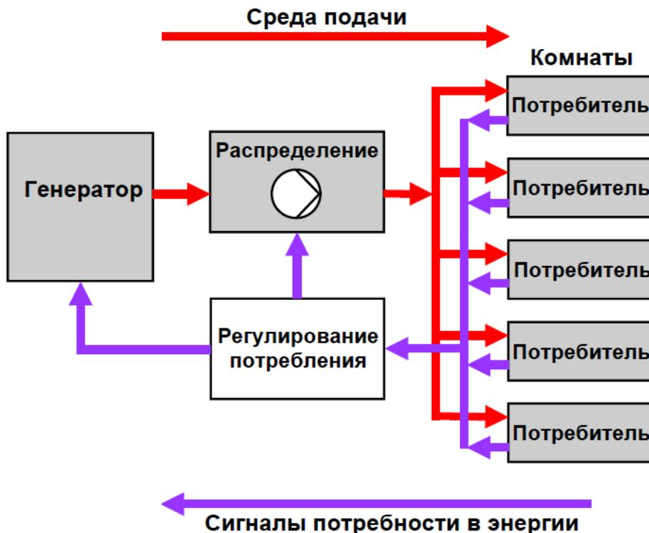
Комнаты (потребители) является объектами спроса на обогрев или на охлаждение. Генератор (источник выработки тепла или холода) и насос (средство подачи и распределения теплоносителя или холодоносителя) должны обеспечивать комфортные условия в помещениях по параметрам
