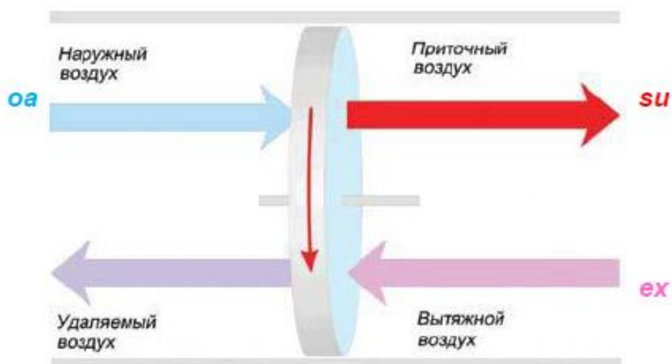
Вытяжной воздух (Extract air) выходит из помещения с температурой 21°C и относительной влажностью 50%. Затем он охлаждается в ячейках ротора. Когда его температура достигает точки росы, водяные пары конденсируются на холодной поверхности ячеек ротора. После поворота барабана потоки наружного воздуха забирают влагу из его ячеек и возвращают в помещение с потоком приточного воздуха, увлажняя его. Такой ротор называется “конденсационный”.
