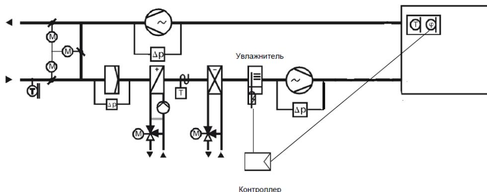
Этот метод более прост по сравнению с косвенным регулированием влажности. Контроллер сверяет показания датчика относительной влажности ф с заданным значением, например 50%, и в случае рассогласования, подаёт команды увлажнителю, соответственно, на увеличение или уменьшение количества влаги, поступающей в приточный воздух.
