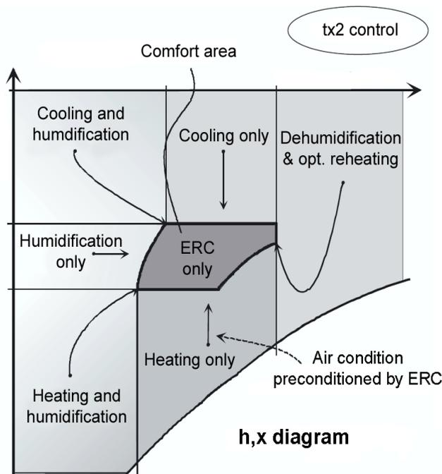
Рекуператор – первый инструмент изменения параметров наружного воздуха на пути воздухоподготовки. Показатели воздуха после рекуператора оцениваются программой, и определяется необходимость в дополнительном
