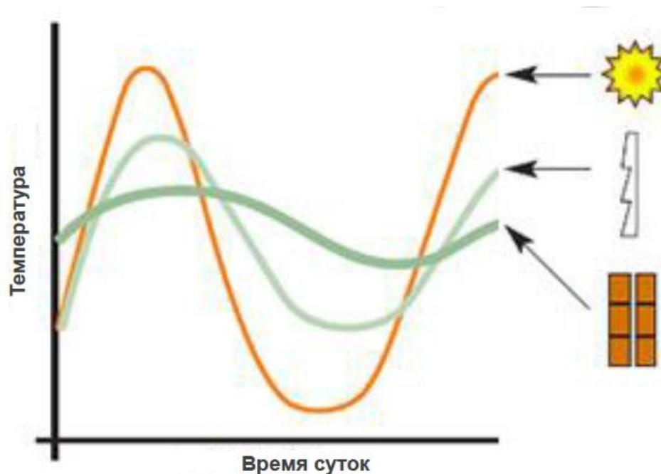
Ограждающие конструкции, включающие в себя фундамент, стены и крышу, создают оболочку здания. Она защищает от внешних погодных воздействий внутренний микроклимат, создаваемый системами жизнеобеспечения, и влияет на ощущения температурного комфорта. Внешняя среда воздействует на здание температурными колебаниями, солнечным излучением, ветром, осадками и т.д. Оболочка здания должна выстоять перед натиском всех этих неприятных для человека воздействий.
