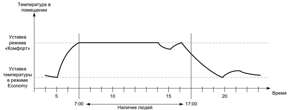
Функция предиктивного управления отоплением использует динамическую модель здания в системе подачи и распределения тепла, которую всегда можно скорректировать в соответствии с текущими измеренными значениями температуры в помещении, температуры подачи и температуры наружного воздуха. Функция способна регулировать подачу тепла также в зависимости от других погодных факторов: солнечное излучение, ветер, осадки.
