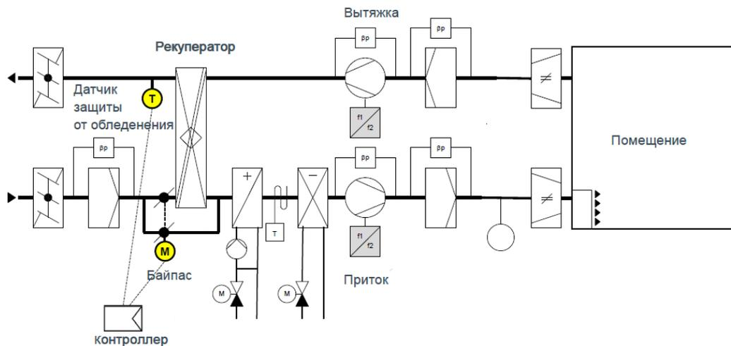
Контроллер получает от датчика защиты от обледенения информацию о понижении температуры воздуха до определённого порога, отделяющего от точки росы, и перераспределяет потоки воздуха, открывая воздушную заслонку на байпасе и прикрывая воздушную заслонку в приточном канале, для уменьшения степени охлаждения вытяжного воздуха.
