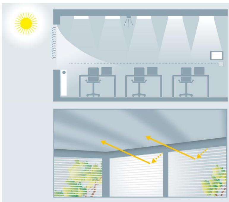
При использовании дневного света могут возникать солнечные блики, которые отрицательно влияют на работоспособность, могут провоцировать заболевания глаз и головные боли. Поэтому жалюзи должны иметь поворотные ламели с возможностью преломления лучей для создания мягкого рассеянного света без солнечных бликов.
