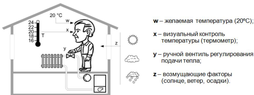
Температура воздуха в помещении изменяется под воздействием внешних факторов. Человек, испытывая температурный дискомфорт, принимает меры. Например, смотрит на стеклянный термометр, видит, что температура отличается от желаемой, и регулирует ручным вентиляем расход теплоносителя радиатора. Избавление человека от необходимости постоянно заботиться о температурном комфорте повышает ощущение комфорта.
