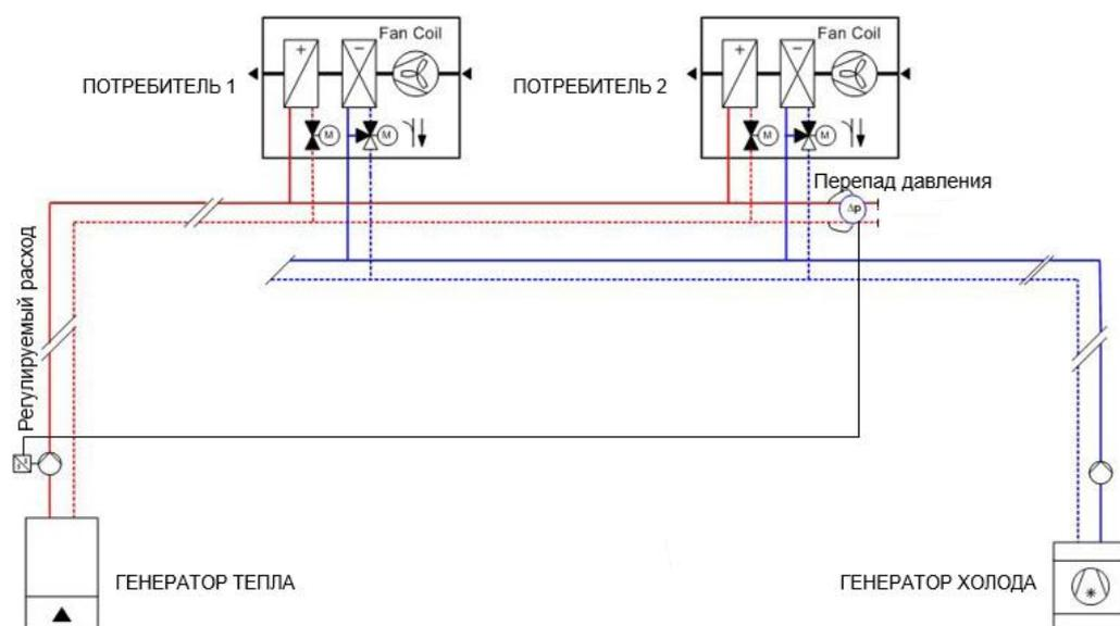
В режиме обогрева контроллер фанкойла реагирует на повышение температуры воздуха в помещении прикрытием регулирующего двухходового клапана теплоносителя. Расход через клапан снижается, а перепад давления на клапане увеличивается.
