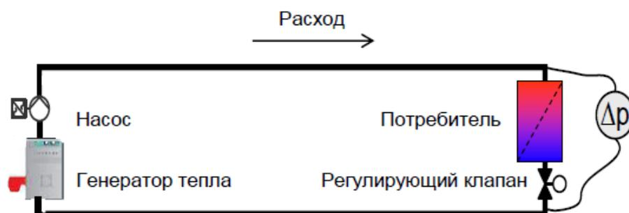
снижение расхода теплоносителя  $V$  на те же 50% приводит к снижению энергопотребления насоса  $P$  уже на 60% за счёт изменения числа оборотов насоса ( $n_1 \rightarrow n_2$ ).
