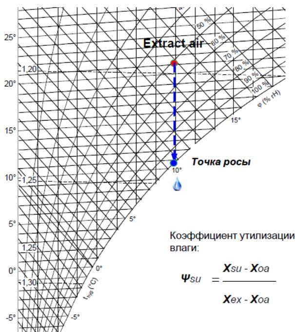
Существует другой тип ротора – “энтальпийный”. Утилизация влаги в нём не зависит от температуры. В этом роторе фольга имеет гигроскопичное покрытие, поглощающее водяные пары из воздуха, что позволяет утилизировать влагу. Зимой влага из вытяжного воздуха поглощается гигроскопичным покрытием и переносится в сухой приточный воздух, увлажняя его. Осушение вытяжного воздуха предотвращает выпадение конденсата в роторной секции, что снижает риск обледенения воздушных
