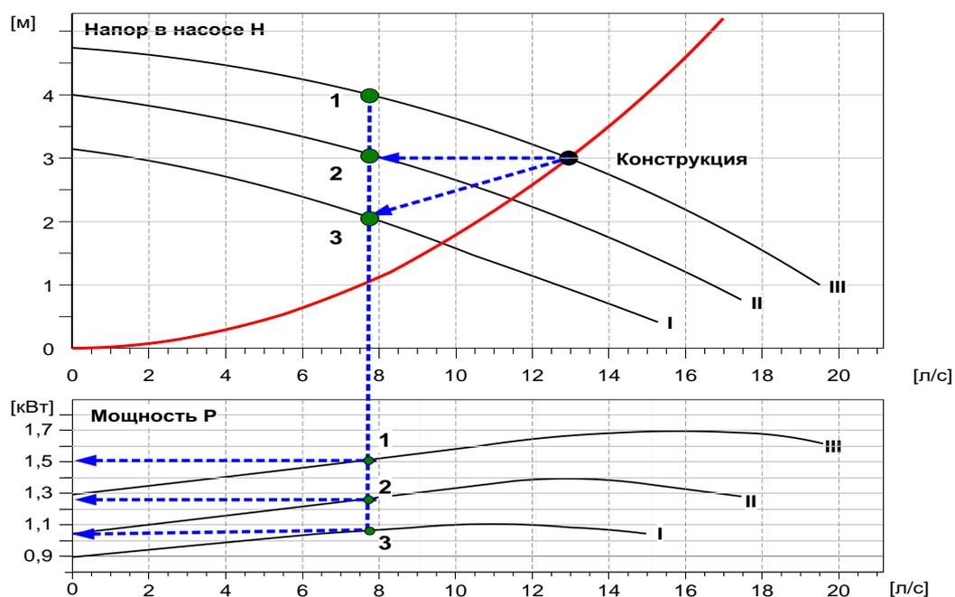
Эту функцию можно использовать только в гидравлических контурах, в которых количество воды при неполной нагрузке меньше, чем при номинальной нагрузке.
