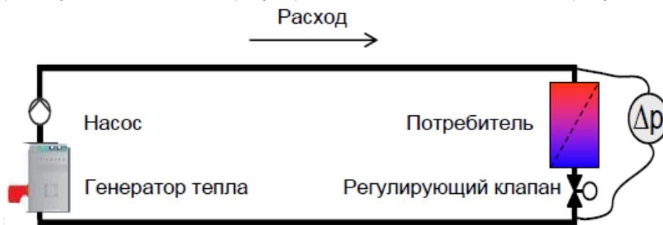
снижение расхода теплоносителя  $V$ , к примеру, на 50% приводит к снижению энергопотребления насоса  $P$  всего на 10%.
