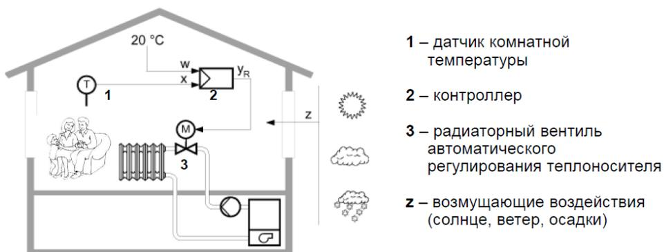
Для этого используется автоматический узел регулирования, где вместо стеклянного термометра установлен температурный датчик, а вместо ручного вентиля – регулирующий клапан с приводом.
