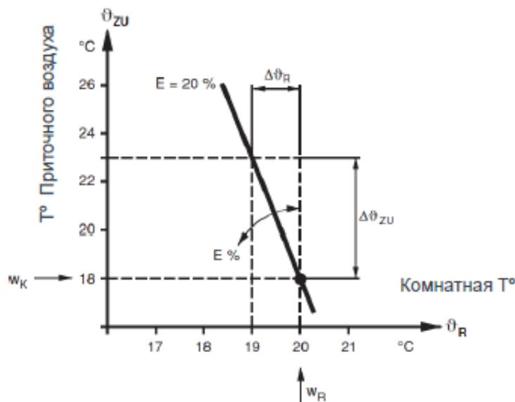
Если комнатная температура воздуха выходит за пределы комфортной зоны и понижается на 1°C, то есть до 19°C, то, в соответствии с графиком, контроллер повышает температуру приточного воздуха в воздуховоде, но уже не на 1°C, а на 5°C, то есть до 23°C. Температура воздуха в помещении возвращается к заданной величине.
