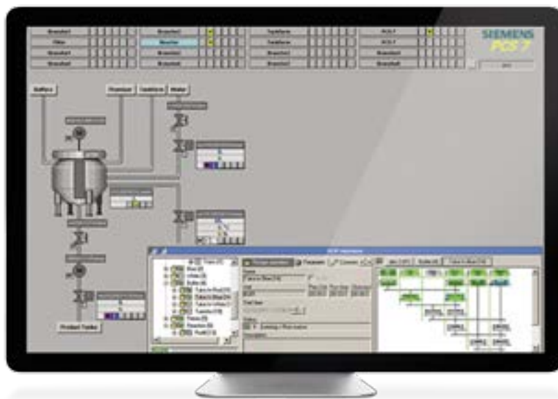
Mit SIMATIC BATCH lassen sich Chargenprozesse effizient planen, steuern und protokollieren.
