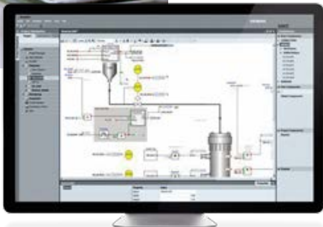
Mehr Effizienz und weniger Risiko: virtuelle Inbetriebnahme und Operator Training mit SIMIT.
