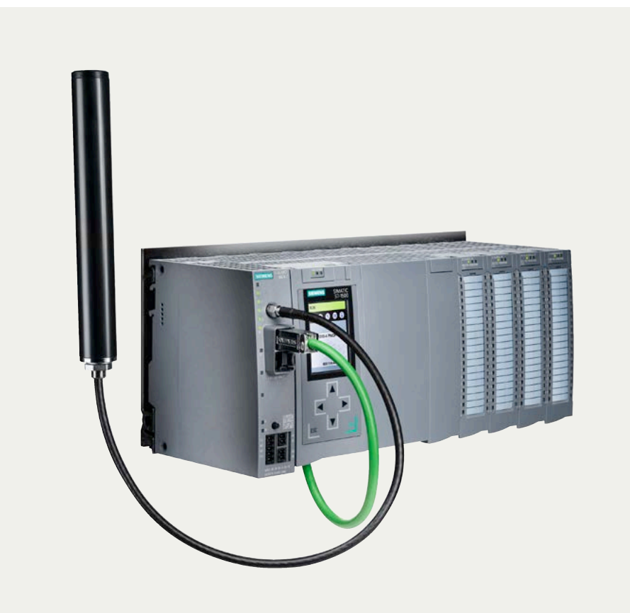
SIMATIC-Module für TeleControl unterstützen Fernwirkprotokolle wie SINAUT ST7, IEC 60870-5-101/104 und DNP3.
