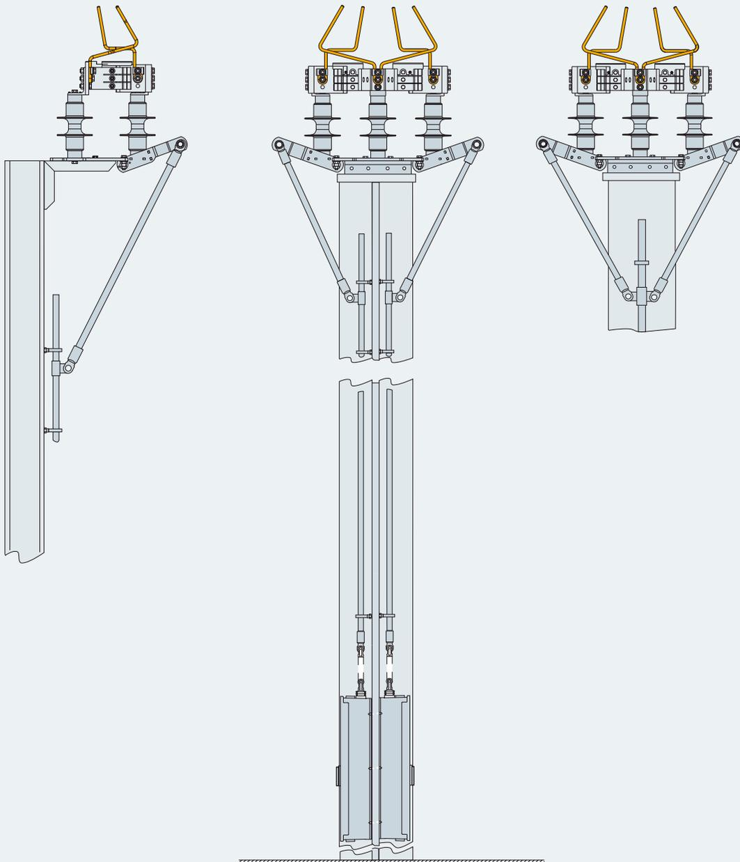
Beispiele für verschiedene Systemeinstellungen mit elektromechanischem Schalterantrieb im GFK-Gehäuse 8WL6134-0B (links), 8WL6134-2 als doppelter Einspeiseschalter (mitte) bzw. als Koppelschalter (rechts)
