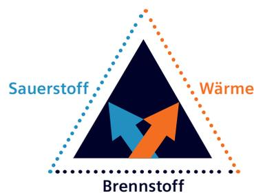
Gas/Wasser-kombinierte Systeme bekämpfen den Brand durch Sauerstoffverdrängung kombiniert mit einem zusätzlichen Kühleffekt.
