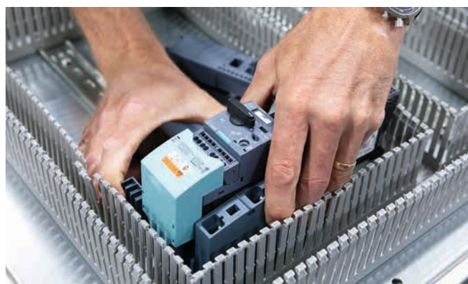
Fjäderanslutning ger snabbare och säkrare montage.
