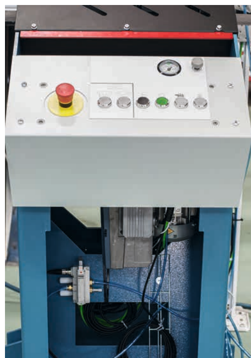
Drivenhet 1 av 3 som ser till att bandet som går genom härdlinjen hålls uppsträckt och drivs framåt genom ugnarna.
