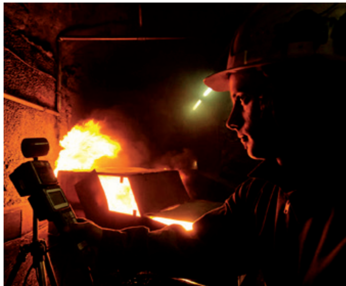
Les experts testent le système FibroLaser dans la galerie d'essais de Hagerbach in Flums en conditions réelles.
