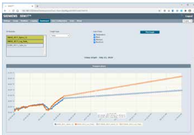
Le tableau de bord SEM3T peut tracer des points thermiques sélectionnés. Ces informations peuvent être utilisées pour identifier rapidement les points chauds potentiels et les transformer en mesures préventives.
