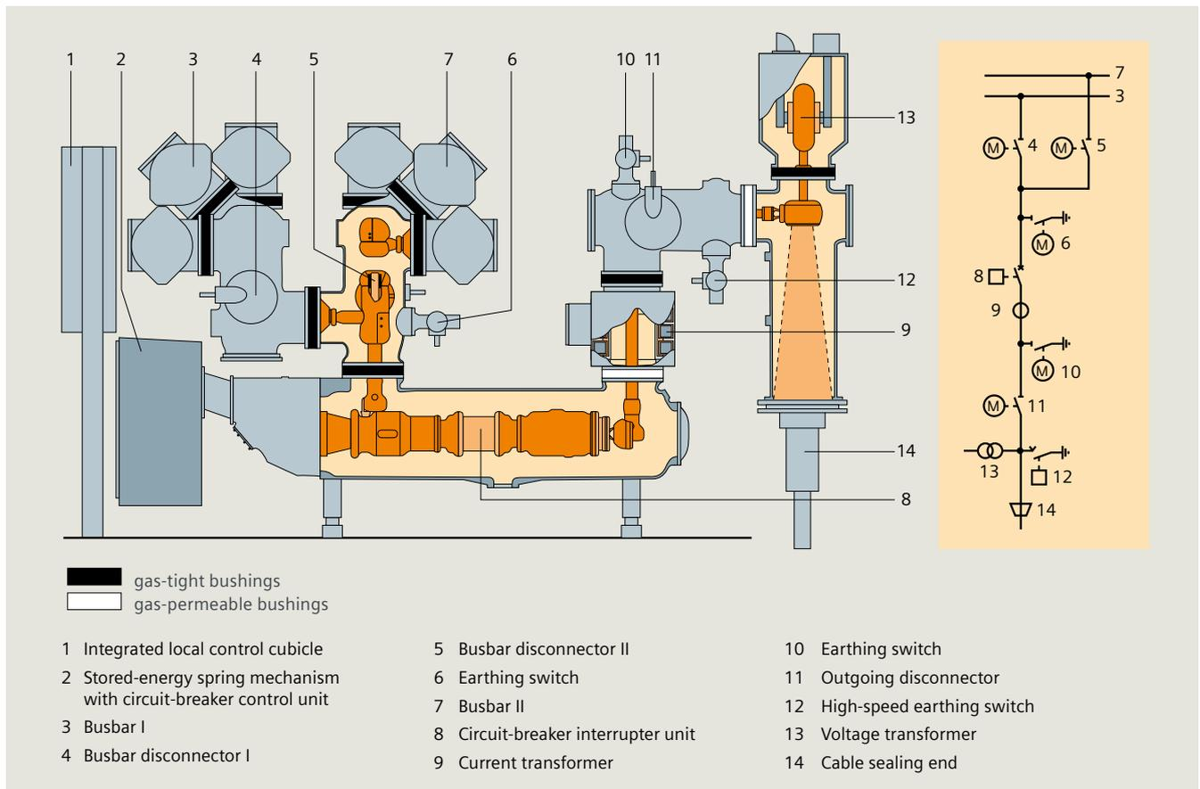
Fig. 3.1-38: 8DQ1 switchgear bay up to 420 kV
