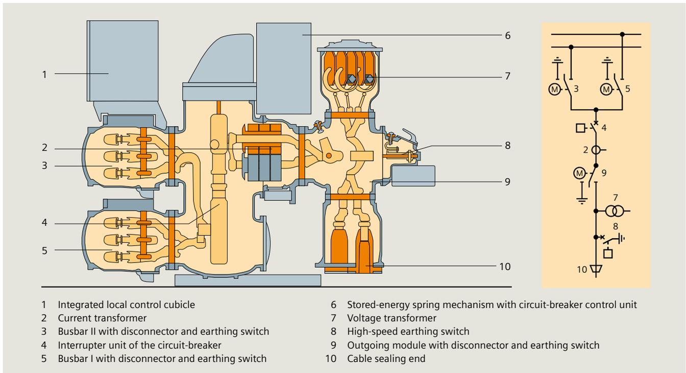
Fig. 3.1-34: 8DN8 switchgear bay up to 145 kV
