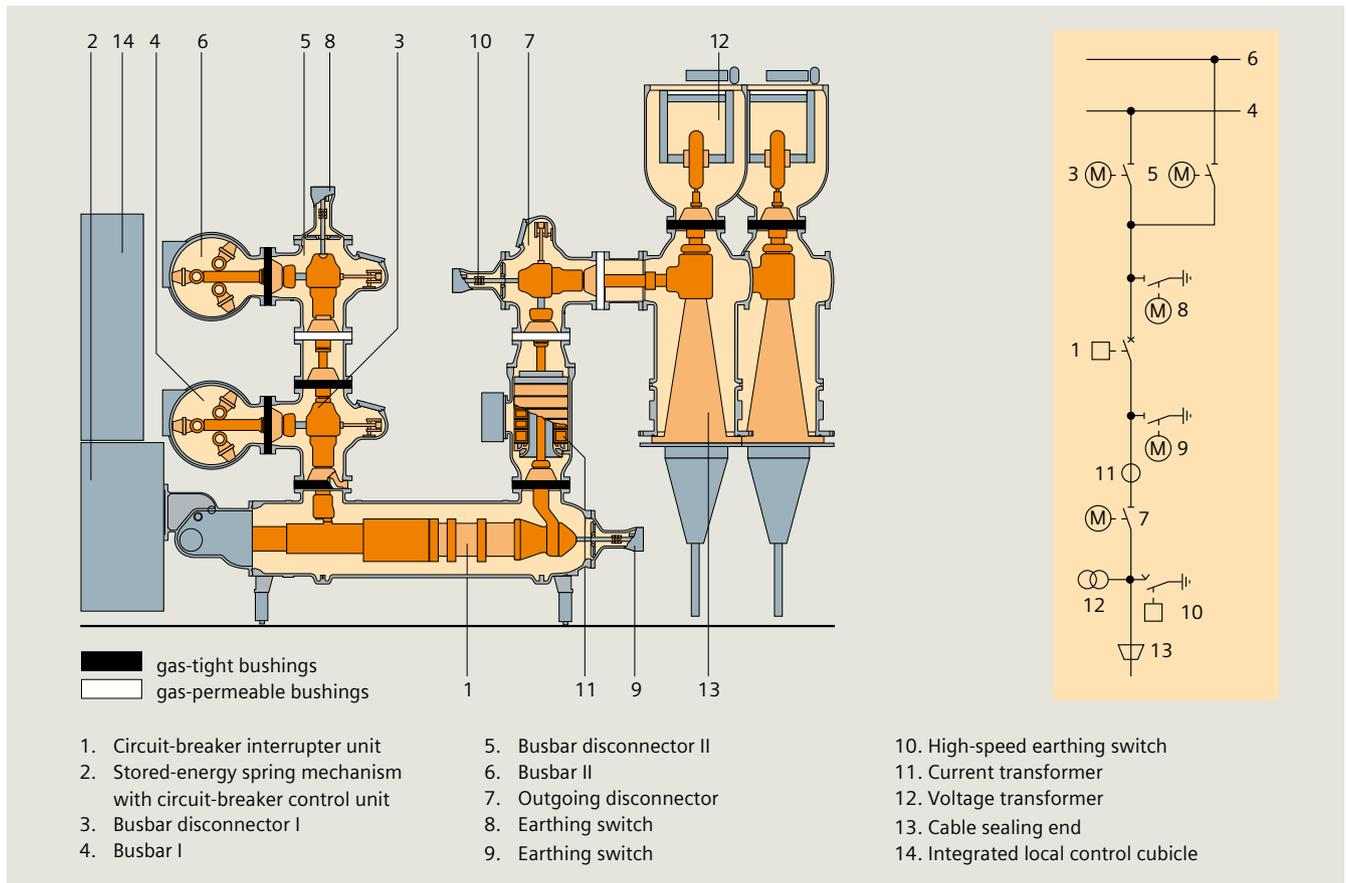
Fig. 3.1-36: 8DN9 switchgear bay up to 245 kV
