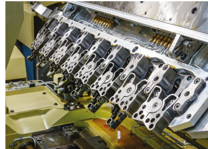
Jede Zange besitzt einen eigenen Servoantrieb und lässt sich dadurch individuell steuern. Die flexible Umformung schont das Material und ermöglicht eine hohe Produktivität.
