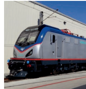
Die Amtrak ACS64 kann die Bremsenergie ins Netz zurückspeisen.
