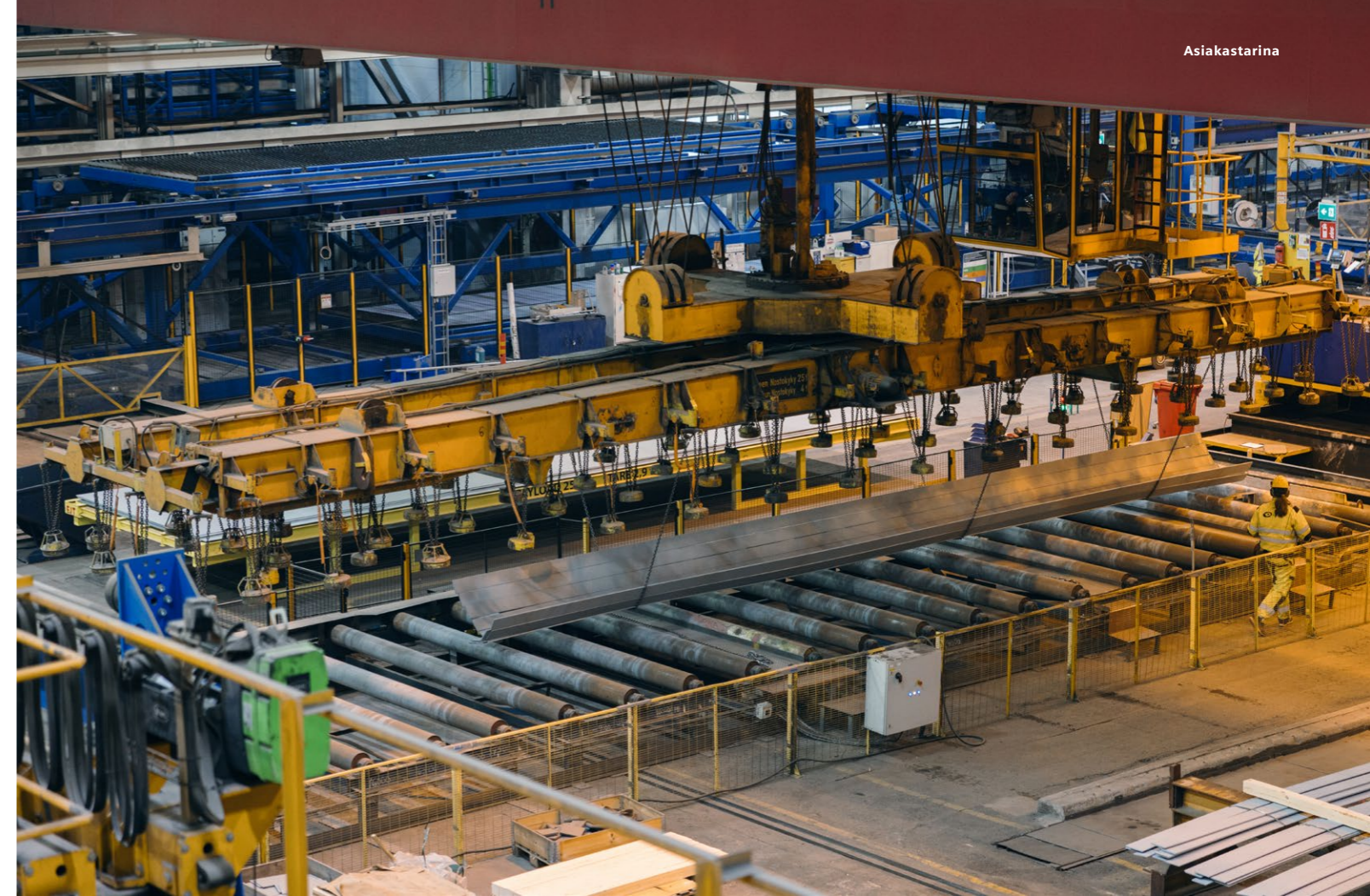
Esikäsitteilylinjalta nostetaan profiileja, jotka vahvistavat laivan kansien osia.
