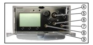
Fig. 220: CAPDIS-S2+, cover open
