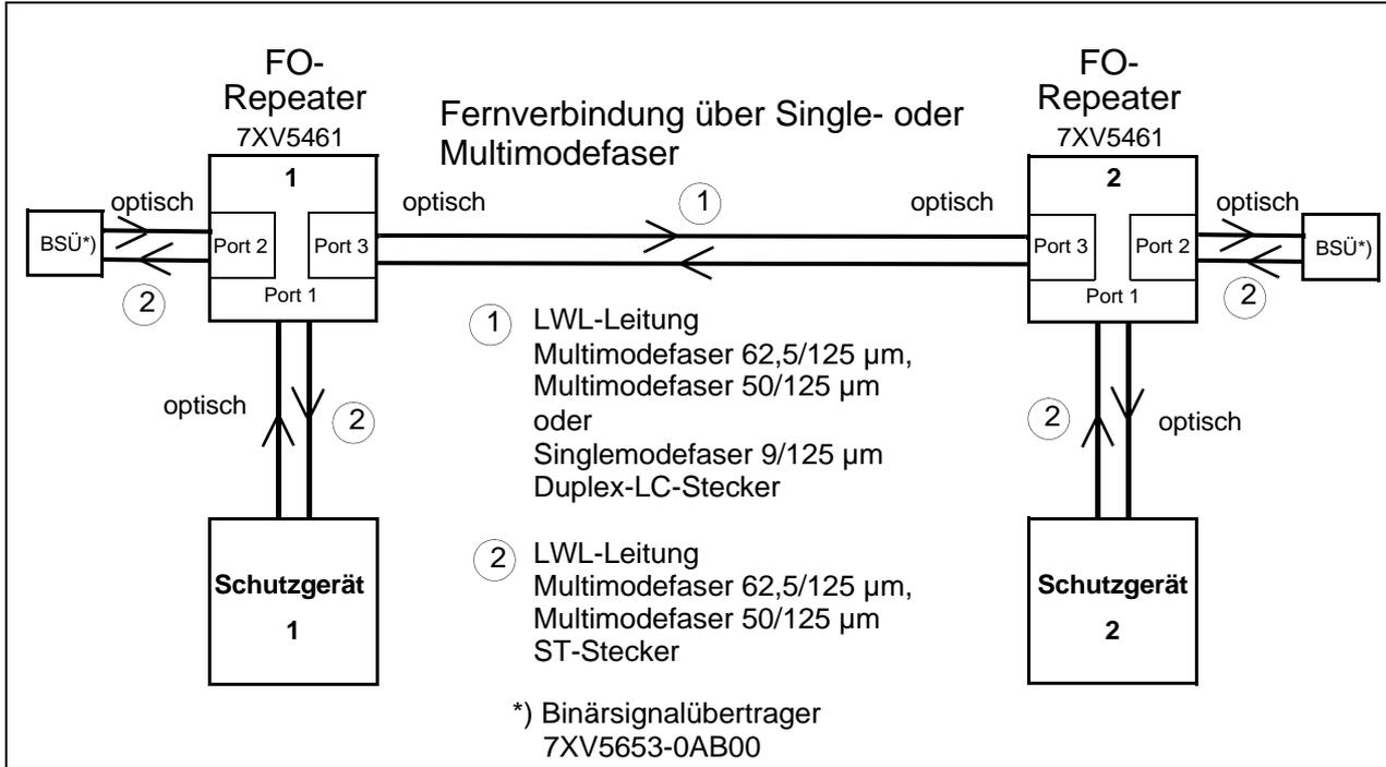
Bild 1 Typischer Aufbau einer Kommunikationsstrecke mit unidirektionalem Repeater
