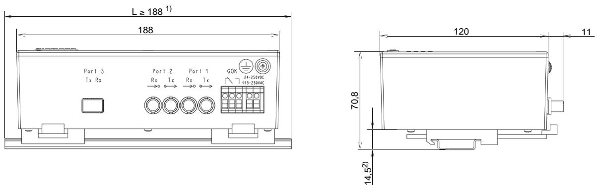
An der Wand montierte Hutschiene gehört nicht zum Lieferumfang
