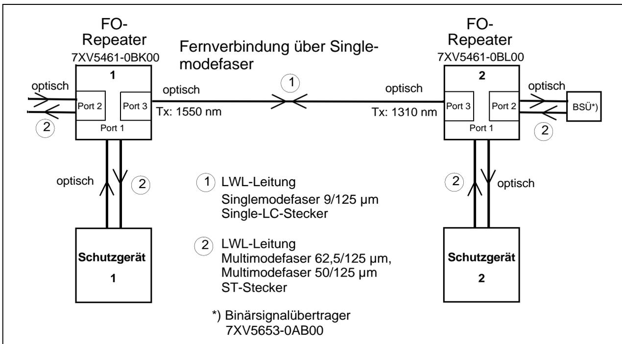
Bild 2 Typischer Aufbau einer Kommunikationsstrecke mit bidirektionalem FO-Repeater
