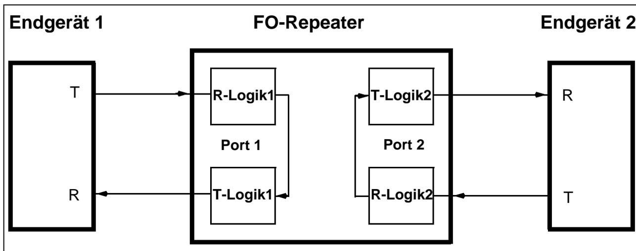
Bild 13 Schematische Darstellung der Betriebsart *Echo Mode*
