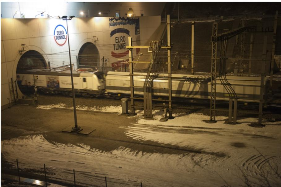
Die Vectron-Lokomotive fuhr durch das französische Portal in den Tunnel ein. Es folgten Traktions-, Brems- und Stromabnehmertests. In Folkestone, Großbritannien, verließ die Lok den Tunnel und kehrte im Anschluss nach Frankreich für eine zweite Testphase zurück. Ziel von Eurotunnel ist es, nicht mehr von sechsachsigen Speziallokomotiven abhängig zu sein, sondern auf vierachsige Standardmodelle zugreifen zu können, um den Schienengüterverkehr zwischen dem Kontinent und
