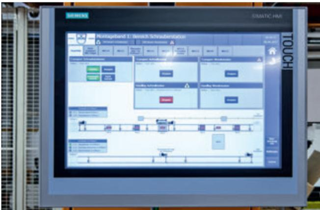
Die TP 1500 Comfort Touchpanels liefern einen Überblick über den Zustand der Anlage und ermöglichen eine schnelle und einfache Fehleridentifikation.
