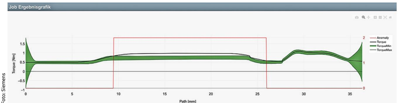
Bild 3: „Analyze MyWorkpiece /Monitor“ zeigt beim Abgleich mit dem Vergleichsmodell, grün dargestellt, eine signifikante Abweichung beim Spindeldrehmoment an und erlaubt so eine gezielte, deutlich kostengünstigere Qualitätskontrolle.
