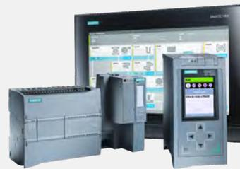
Système d'automatisation évolutif sur la base de Simatic S7 pour commander et réguler des installations primaires. Si nécessaire, aussi en version ultra-disponible (redondance). L'ingénierie est réalisée avec Step 7 ou dans le TIA Portal avec une bibliothèque de solutions autonome. Visualisation avec panneau tactile et/ou intégration dans un système maître disponible (par ex. WinCC, PCS7, Wizcon, PVSS, etc.)
