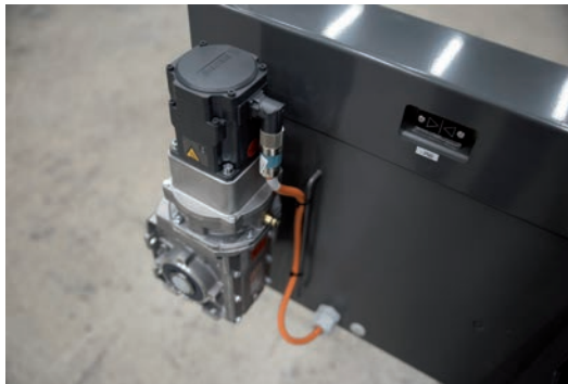
1FK2-servomootorissa on yhden kaapelin teknologia.
