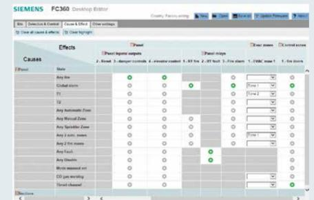
Nella maggior parte dei sistemi tutti i dispositivi di allarme e le uscite di controllo devono attivarsi con ogni allarme incendio. Tale funzione è disponibile di default. Quando sono necessari controlli più complessi, la matrice causa-effetto dell'FC360, unica nel suo genere, rende semplice e logica qualsiasi modifica richiesta.
