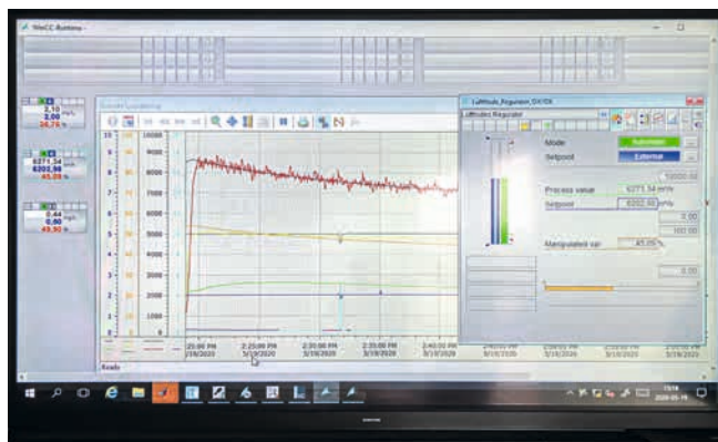
Exempel på trendvisning med mätvärden i virtuell reglerkrets i Simatic PCS 7.
