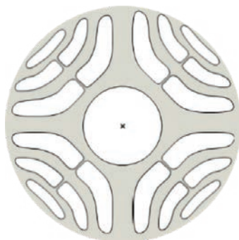
På tværsnittet af rotoren ses pladerne, som passer til banerne for de 4-polers magnetfelt
