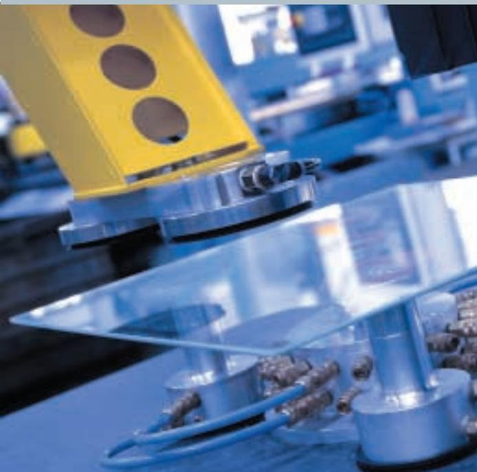
**Mit den Saugern der Vakuumfixierung lässt sich die Schleifmaschine schnell an jede Scheibenform anpassen**
