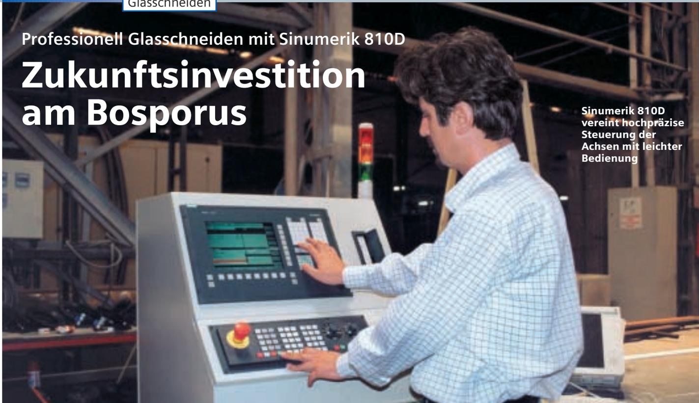
Auf den Stand-alone-Glasschneidmaschinen der türkischen Firma CMS lassen sich Glasplatten im Jumboformat millimetergenau in gerade oder kurvige Teile schneiden. Seit der Ausrüstung mit der modernen und kompakten CNC-Steuerung Sinumerik schneiden die Maschinen noch präziser und die Schneidgeschwindigkeit erhöhte sich um das Dreifache.
