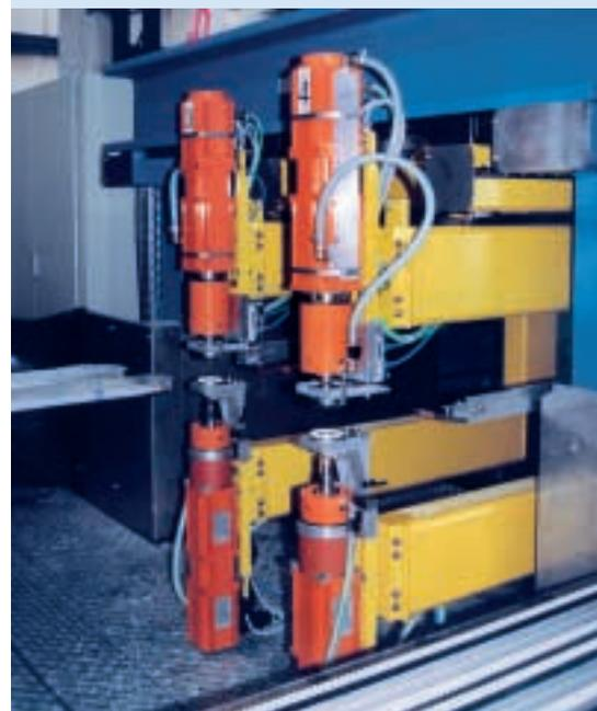
Das NC-Programm für die Anlage erstellt Benteler selbst. Per Ethernet wird der Teil, der gerade auftragsmäßig benötigt wird, von einem Server auf die Steuerung der Maschine übertragen. Die Programmauswahl erfolgt über ein Sinumerik-Pult, sodass der Bediener von einem Anlagenteil aus alle anderen Maschinen mit dem neuen Programm versorgen kann. ■
