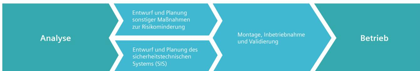
Die spezifizierten Sicherheitsfunktionen werden während der Planungsphase umgesetzt. Bei Verwendung der SIMATIC S7 Safety Matrix liegen die in der Analysephase definierten Sicherheitsfunktionen in Form einer Ursache-Wirkungs-Matrix vor, die ohne Einschränkungen direkt weiter genutzt werden kann.
