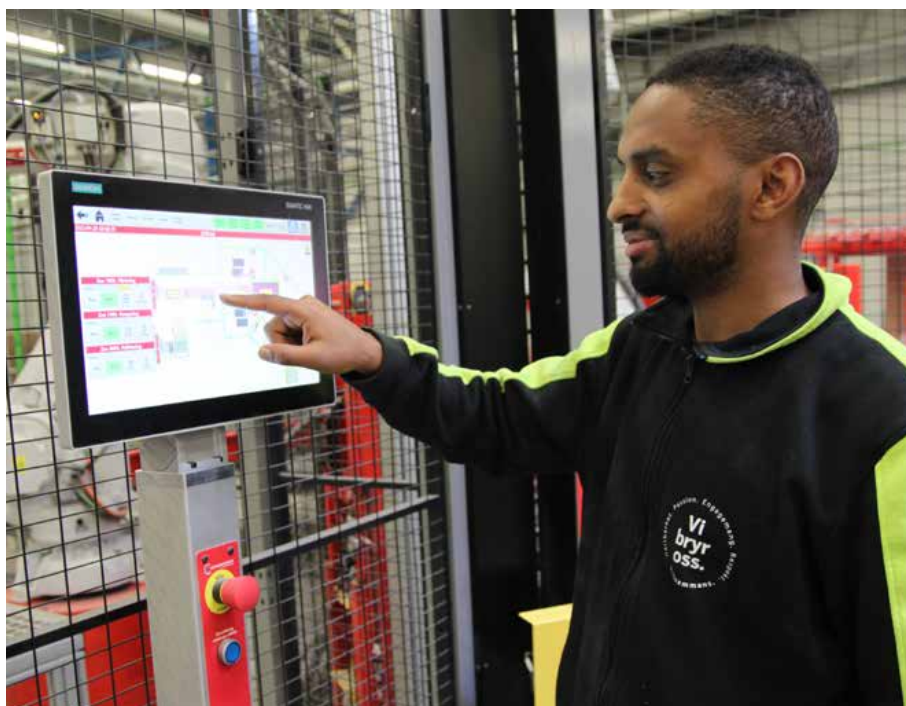
Alla interface är standardiserade så att maskinoperatörerna känner igen sig vid olika stationer; här Haben Issak vid en av paketeringslinjens fem Simatic HMI TP1500 Comfort Pro-paneler.
