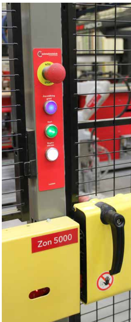
Sirius Act-tryckknappar med Profinetkabel i stolpen sparar mycket installationstid.
