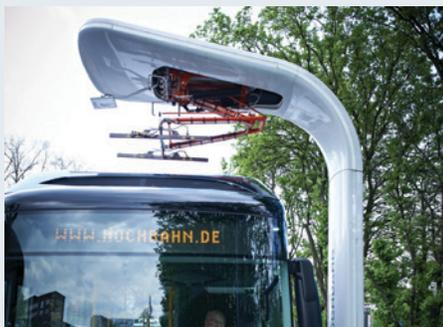
Pantographe à installation en bordure de rue
