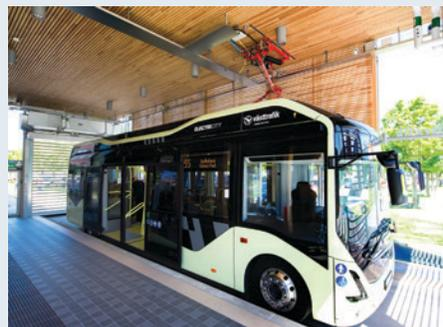
Pantographe à installation au plafond
