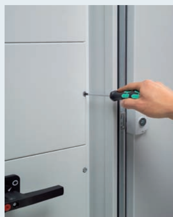
Chiusura delle coperture tramite viti a \frac{1}{4} di giro che garantiscono il collegamento equipotenziale della copertura
