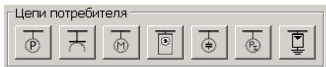
В общем случае, конечные цепи потребителей можно добавлять в схему сети, выбрав значок нужной конечной цепи в библиотеке. Затем нужно найти подходящую точку вставки (желтый прямоугольник) путем перемещения указателя мыши на схеме сети вдоль линии распределения, вставив конечную цепь нажатием и удержанием левой кнопки мыши, перетаскивая курсор мыши от точки вставки и окончательно отпустив кнопку мыши в выбранной точке вставки.
