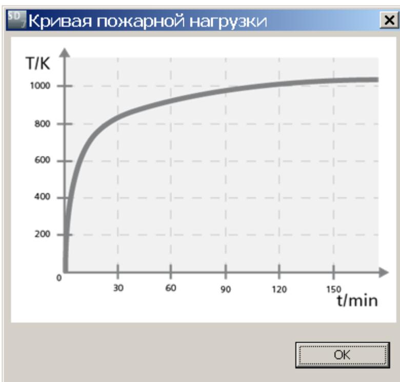
Вы можете вызвать кривую пожарной нагрузки информационной кнопкой, расположенной рядом с выпадающим списком температур падения напряжения/условия расцепления. Эта кривая поможет Вам при выборе соответствующей температуры.
