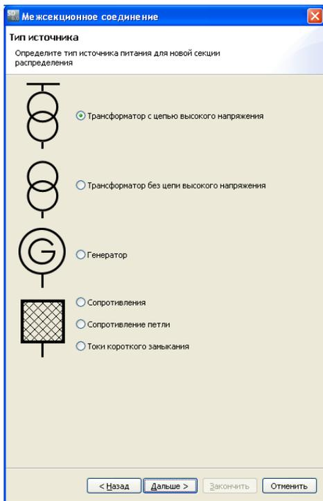
В третьем окне определяется тип ввода для нового главного распределительного щита.
