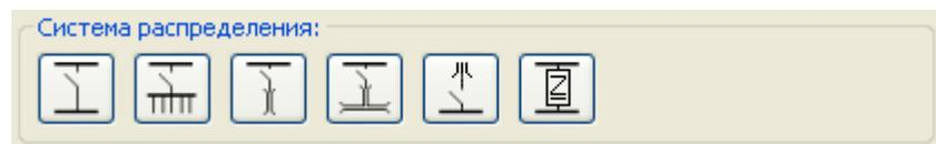
В общем случае распределительные системы можно вставлять в схему сети, выбрав нужный значок в библиотеке. Затем нужно найти подходящую точку вставки (желтый прямоугольник) путем перемещения указателя мыши на схеме сети вдоль распределительной линии, и вставить распределительную систему нажатием и удержанием левой кнопки мыши, перемещая курсор мыши от точки вставки и окончательно отпустив кнопку мыши в выбранной точке вставки.
