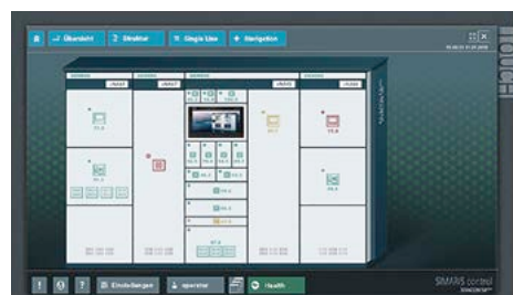
Schaltanlage SIVACON S8plus – Health Index
