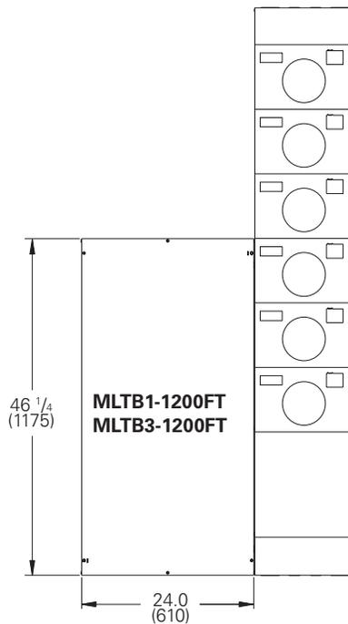
Remarque : Pour un boîtier de branchement d'alimentation directe de 1 200 A, l'assemblage standard est pour le montage à gauche. Pour le montage à droite, les barres omnibus et les supports isolés doivent être déplacés vers l'autre ensemble d'orifices, identifié par un « R » avant l'installation murale.
