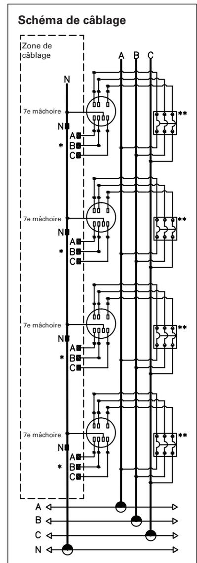
① Les disjoncteurs de circuits secondaires ne doivent pas dépasser les caractéristiques de l'embase
