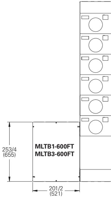
Configurations avec boîtier de branchement d'alimentation directe de 1 200 A
