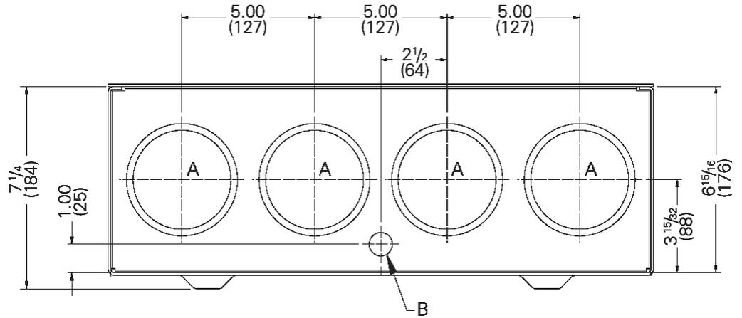
Données des débouchures pour paroi d'extrémité supérieure de la colonne de compteurs - Pouces (mm)
