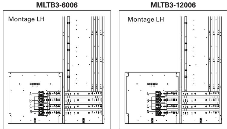
Remarque : Un boîtier de branchement standard peut être installé du côté droit de la colonne de compteurs, au besoin.
