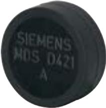
10x4,5 mm (ØxH), ISO 15693, Frequenz 13,56 MHz, FUJITSU MB89R118, 2.000 Byte FRAM Anwenderspeicher, kleben, nicht bedruckbar, bis +100 °C, IP67, 8 mm Reichweite.
