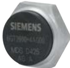
24x10 mm (ØxH), ISO 15693, Frequenz 13,56 MHz, FUJITSU MB89R118, 2.000 Byte FRAM Anwenderspeicher, Schrauben (M6), nicht bedruckbar, bis +125 °C, IP68, 45 mm Reichweite.
