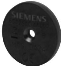
27x4 mm (ØxH), ISO 15693, Frequenz 13,56 MHz, FUJITSU MB89R118, 2.000 Byte FRAM Anwenderspeicher, Schraube M3, kleben, nicht bedruckbar, bis +100 °C, IP67, 300 mm Reichweite.
