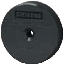
30x8 mm (ØxH), ISO 15693, Frequenz 13,56 MHz, FUJITSU MB89R118, 2.000 Byte FRAM Anwenderspeicher, Senkkopfschraube M4 auf Metall, nicht bedruckbar, bis +100 °C, IP68, 80 mm Reichweite.
