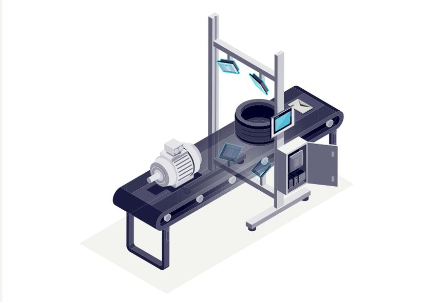
Vorkonfiguriert und sofort einsatzbereit: Unser System zur Erkennung und Verfolgung von Objekten auf Förderbändern mittels RFID. Geprüfte Komponenten und „UHF for Industry“-Algorithmen bilden ein zuverlässiges Lesesystem für die Reifenindustrie, Intralogistik und diskrete Fertigung.
