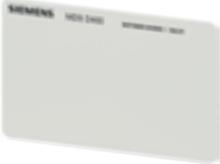
85x54x0,8 mm (LxBxH), ISO 15693, Frequenz 13,56 MHz, FUJITSU MB89R118, 2.000 Byte FRAM Anwenderspeicher, kleben, beidseitig bedruckbar, bis +60 °C, IP67, 650 mm Reichweite.
