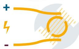
Durch die Bewegung im Magnetfeld wird in der Spule eine Spannung induziert, die einen Strom über einen Kommutator oder Gleichrichter fließen lässt.
