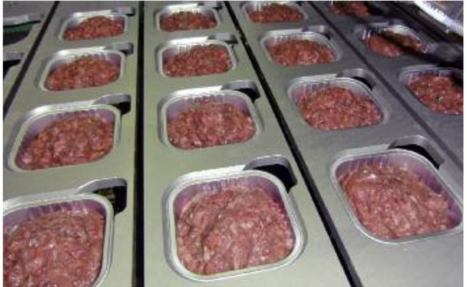
Die mit dem Tiernahrungsprodukt befüllten Aluschalen laufen auf vier Bahnen zum nächsten Prozessschritt, der Siegelstation.
