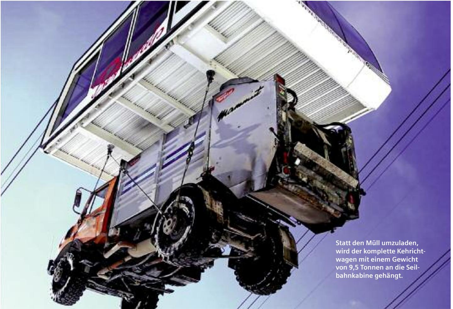
Statt den Müll umzuladen, wird der komplette Kehrichtwagen mit einem Gewicht von 9,5 Tonnen an die Seilbahnkabine gehängt.
