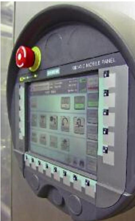
Handeingriffe und Überwachung der Anlage erfolgen über ein Mobile Panel 277F IWLAN, welches drahtlos per Industrial Wireless LAN an die Hauptsteuerung angebunden ist.
