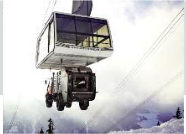
Die Seilbahn auf die autofreie Bettmeralp (VS) ist die Nabelschnur für den Ferienort: Menschen und Güter werden damit transportiert. Damit der Müll nicht umgeladen werden muss, wird der 9,5 Tonnen schwere Kehrichtwagen an die Kabine gehängt. Die Seilbahn wird dabei von einer fehlersicheren Steuerung überwacht.
