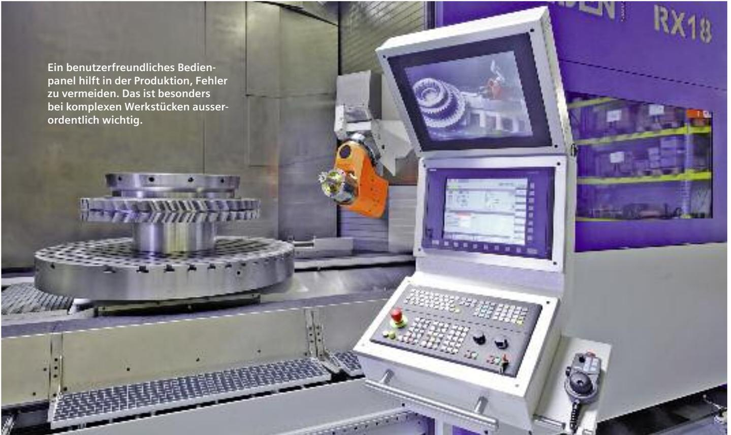
Drehbänke und Fräsmaschinen stehen in einer Werkstatt oft unmittelbar nebeneinander. Von der Bedienung her sind es zwei komplett verschiedene Maschinen. Hier dreht sich das Werkstück, dort der Fräskopf. Für viele Endprodukte wäre aber eine Kombination beider Maschinen ideal.
