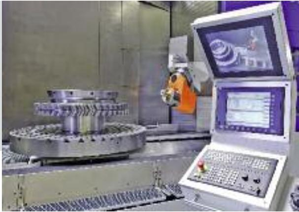
Es gibt Werkstücke, die will man nicht zweimal in die Maschine einspannen: Zum Beispiel ein tonnenschweres Zahnrad mit 1,8 Metern Durchmesser. Ein neu entwickeltes Fünffachs-Fräsceter der Firma Reiden Technik kombiniert Fräsen und Drehen in einer Maschine und bearbeitet so bis zu fünf Tonnen schwere Werkstücke.
