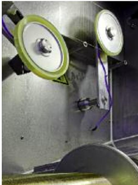
Ein Ab- und ein Aufwickler – jeweils mit eigener Tänzerregelung für konstante Drahtspannung – übernehmen den Transport des mehrere hundert Kilometer langen Drahtes mit einer Geschwindigkeit von bis zu 20 m/s.
