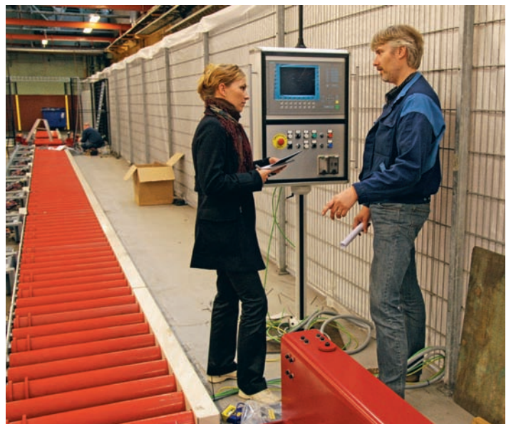
Operatörerna får montageinstruktioner via multipaneler, Simatic Multi Panel MP 277, som sitter längs banan. Via panelerna kan de också manövrera motorer, rack och lyftbord. Kommunikationen går via Ethernet.
