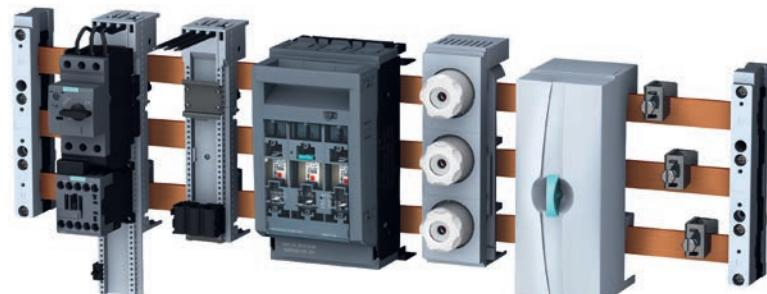
I mange styretavler bruges det standardiserede 60 mm skinnesystem som effektfordelelse til motorstartere og andre belastninger som fx varmelegemer. Systemet giver en høj grad af fleksibilitet i tavlen og giver desuden en let og hurtig montering.
