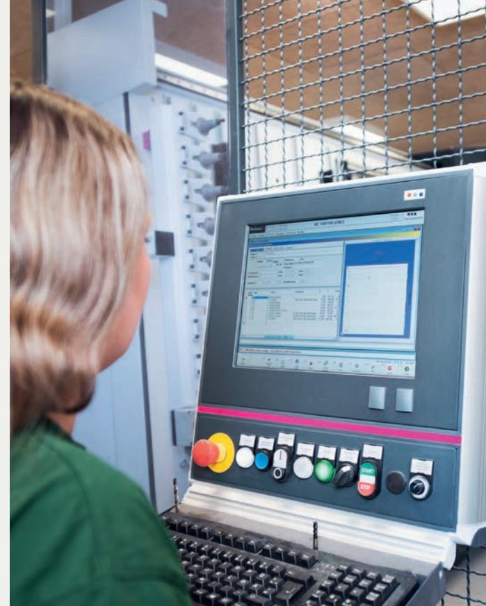
Fra projektafdelingen sendes tavlens data og virtuelle tegning til bearbejdningsanlægget, som fræser alle huller i stålkabinetten i en fuldautomatisk proces.
